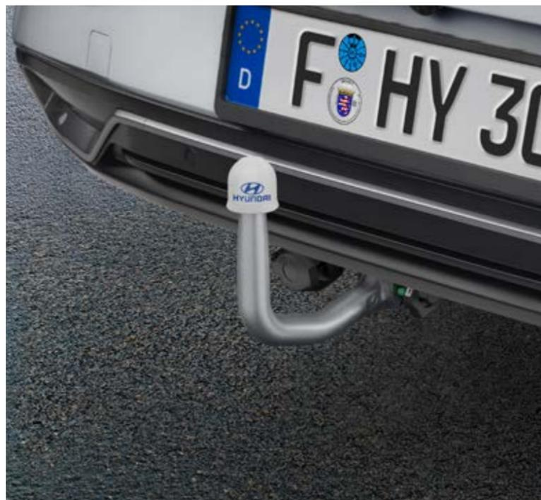
Enganche de remolque, desmontable
